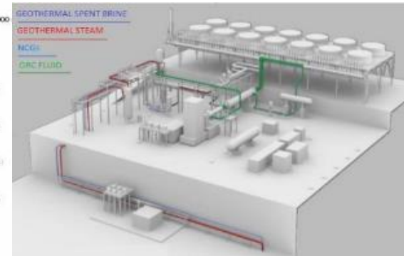
Centrale raffreddata ad aria senza emissioni aeriformi, adiacente alla piazzola di perforazione
